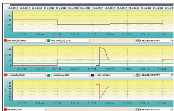
Obr. 2. Detail záznamu napětí a proudů spolu se záznamem proudového impulsu
